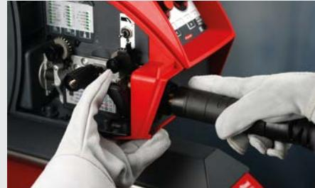
/ Fronius sistemski priključek (FSC) omogoča zanesljiv in enostaven priklop gorilnika brez uporabe orodja. Gorilnik se popolnoma približa pogonu in zagotavlja optimalen pomik varilne žice.
